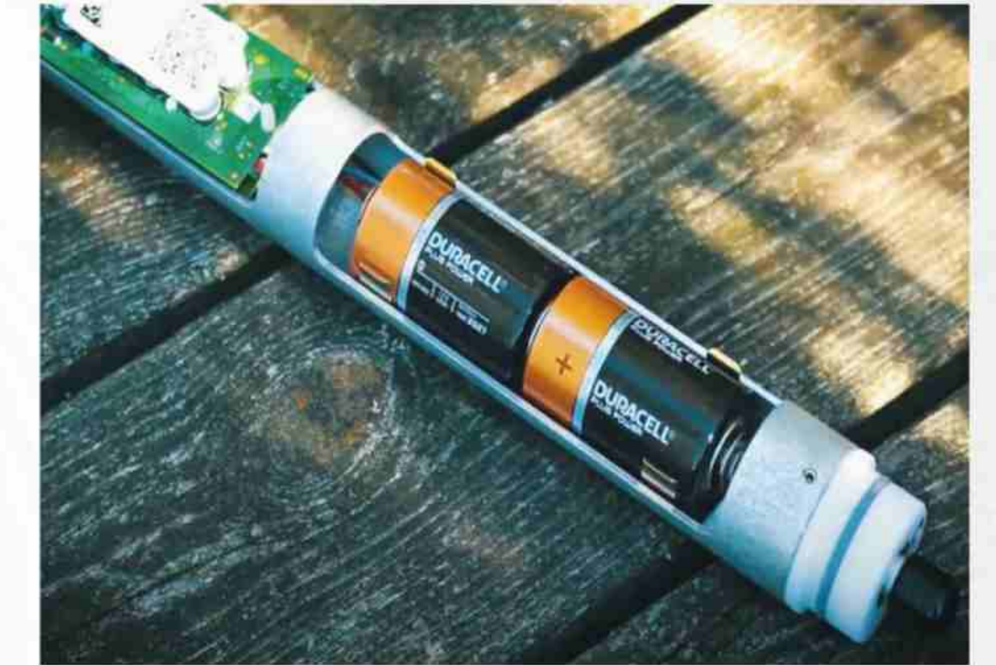
▲ D셀 배터리 사용으로 상전 및 부가적 설치가 필요치 않아 간편한 설치 및 유지보수 가능
